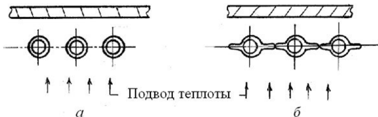
Рис. 2. Схема выполнения топочных экранов а — из обычных труб; б — из плавниковых труб
